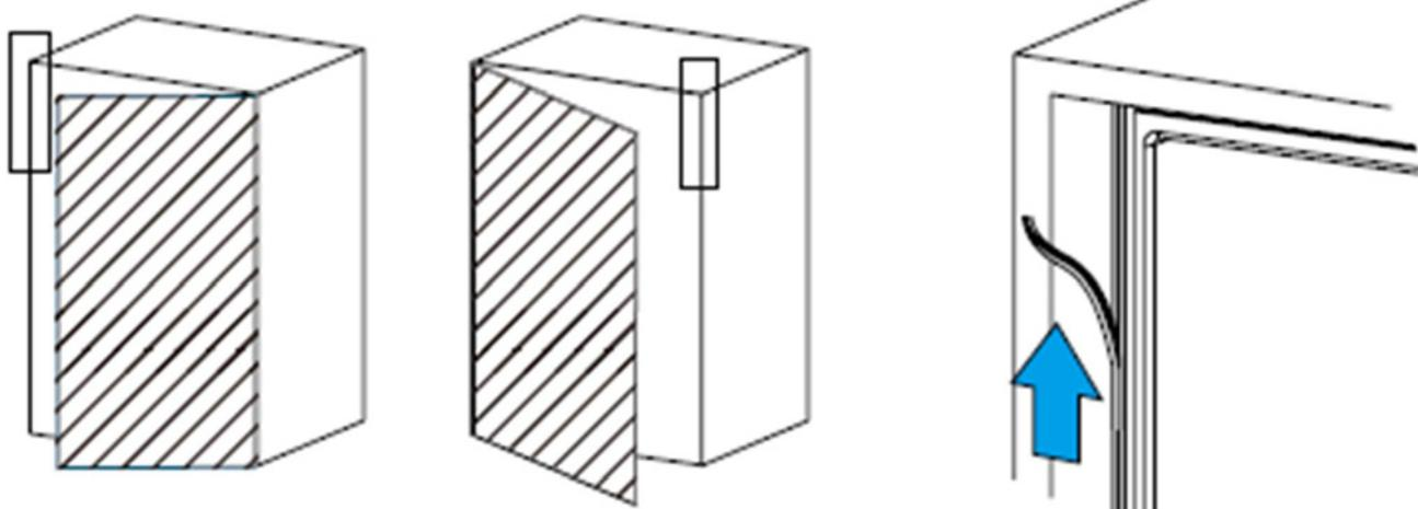
**5.** Установите элементы для фиксации изделия, как указано на рисунке. Закрепите прибор в шкафу с помощью шурупов.
