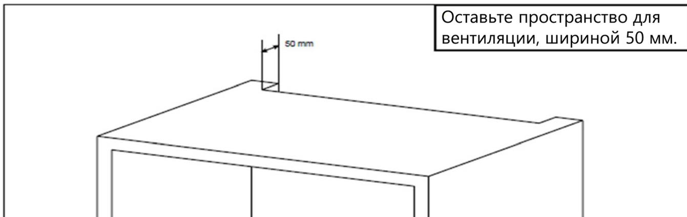
Сделайте зазор для вентиляции в верхней части шкафа. Воздушному потоку ничто не должно препятствовать. Рекомендуемый размер зазора: 500 x 50 мм.
