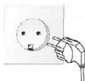
Для обеспечения электробезопасности морозильная камера должна быть подключена к сети электропитания с помощью индивидуальной розетки с заземляющим контактом.
