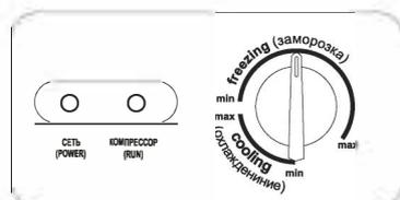
Необходимая температура в морозильном ларе устанавливается и контролируется термостатом. Температура в ларе задается в соответствии с установленной температурой хранения продуктов.
