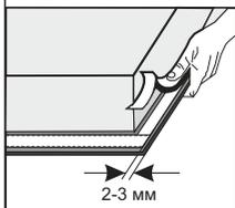
Плита снабжена специальным уплотнением, предназначенным для предотвращения попадания жидкости внутрь мебели.
