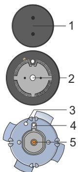
Горелки снабжены защитным устройством контроля пламени (УКП). Если пламя в горелке случайно погаснет (например, при пролипании кипящей жидкости или при сильном сквозняке в помещении) подача газа автоматически прекращается во избежание его концентрации в помещении.
