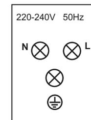
Цветовая маркировка L = внешние провода под напряжением, обычно черного или коричневого цвета. N = нейтральный провод. Обычно синего цвета. Убедитесь в правильном подсоединении нейтрального провода!
