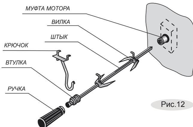
Установите крючок, для чего вставьте «усы» крючка в пазы верхней полки слева проема духовки и опустите крючок вниз (рис.13).
