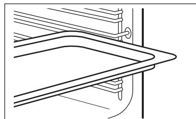
Одновременная установка решетки и эмалированного противня /сотейника:
