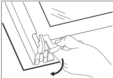
6. Поверніть два фіксатори на 90° і вийміть їх із гнізд.
