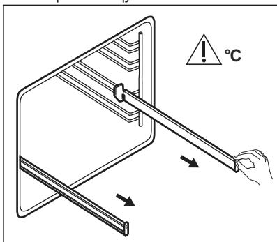
Обязательно полностью задвиньте телескопические направляющие внутрь духового шкафа перед тем, как закрыть дверцу духового шкафа.
