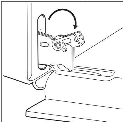
3. Закрійте дверцята духової шафи до першого фіксованого положення (наполовину). Потім підніміть і потягніть дверцята вперед, вимаючи їх із гнізд.
