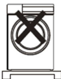
Установка на кронштейн
