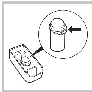
Лоток 4 для отбелителя вставляется в отделение 1 распределителя моющих средств. Не заполняйте лоток 4 выше отметки max (см. рис.). Для осуществления только отбеливания налейте отбелитель в дополнительную
