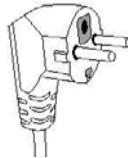
Данный прибор должен быть заземлен. В случае короткого замыкания, заземление уменьшает риск электрического поражения, так как при нем предусмотрен провод, по которому уходит электрический ток. Данный прибор оснащен шнуром с проводом и вилкой заземления. Вилку необходимо вставлять в должным образом установленную и заземленную розетку.
