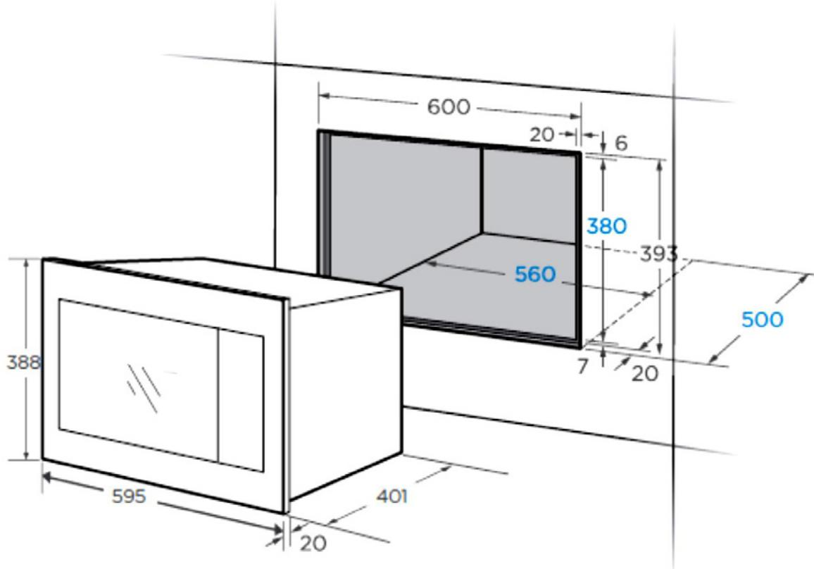
Задняя панель корпуса встраиваемой печи не должна быть закрыта задней стенкой кухонной мебели.
