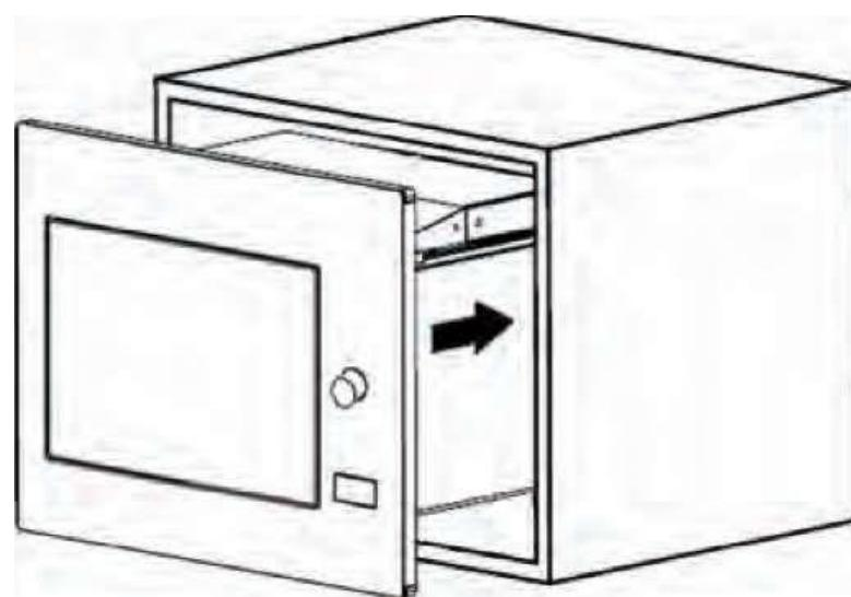
5. Откройте дверь, зафиксируйте СВЧ в установочном отверстии в мебели с помощью болтов, затем зафиксируйте ориентир в установочном отверстии
