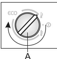
Если температура в помещении, где установлен прибор, ниже +16 °C, рекомендуем установить переключатель **A** в положение .
