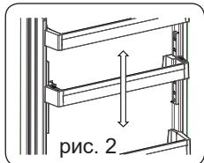
Расположите дверную полку на желаемой высоте, переместив ее вверх или вниз. После установки дверной полки в требуемое положение отпустите кнопки, расположенные по бокам дверной полки (рис. 2). Прежде чем отпустить полку, попробуйте переместить ее вверх или вниз, чтобы убедиться в надежности ее крепления.
