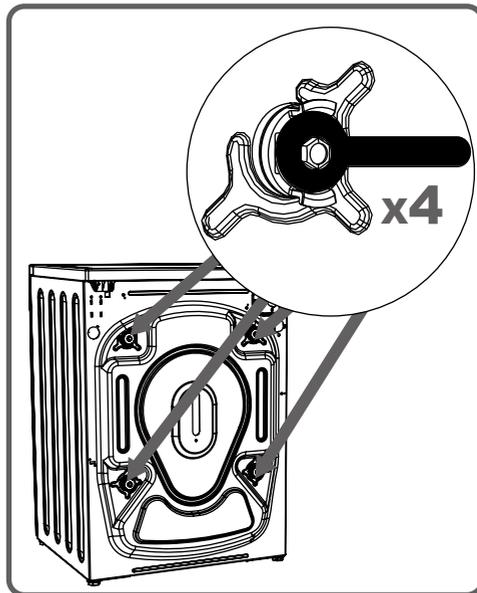
Вытащите предохранительные транспортировочные винты.
