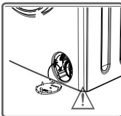
На стенках отделений контейнера для моющих средств со временем могут образоваться твердые отложения. Для очистки этого осадка выньте контейнер для моющих средств. Рекомендуется очищать фильтр насоса раз в два месяца.
