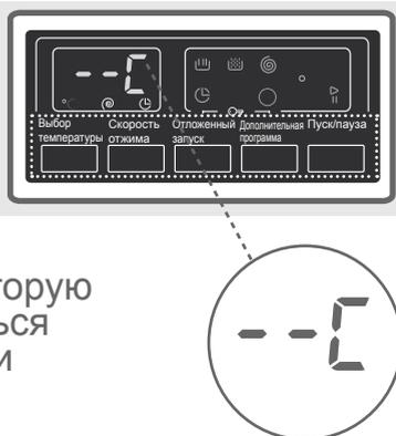
Если вы пропустили температуру, которую хотели выставить, вы можете вернуться к ней, нажимая на кнопку регулировки температуры воды.
