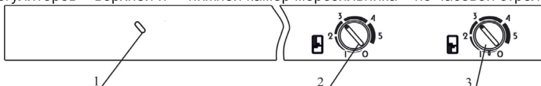
Рис.2 Схема расположения элементов управления и сигнализации 1 – зеленая индикаторная лампа (сеть); 2 – ручка терморегулятора верхней камеры морозильника; 3 – ручка терморегулятора нижней камеры морозильника
