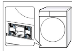
3. Снимите крышку теплообменника, используя ручку.
