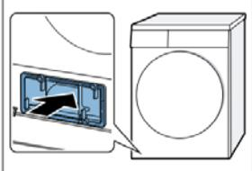
2. Закройте рычаг крышки теплообменника.
