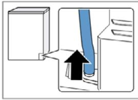
Шланг для отвода конденсата установлен на разъеме на заводе.
