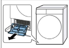
5. Промойте вставку под проточной водой и высушите.
