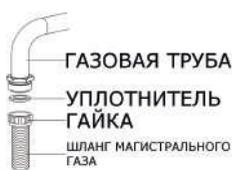
Для подключения к магистральному газу установите прокладку в гайку на конце шланга. Закрутите гайку шланга на резьбу магистральной трубы прибора, проверьте соединение на предмет утечки газа.
