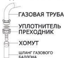
Для подключения к газовому баллону установите хомут на шланг газового баллона. Установите переходник в гибкий шланг газового баллона, предварительно нагрев конец шланга в кипящей воде. Зафиксируйте хомут на конце шланга и закрутите фиксирующий винт хомута при помощи инструмента. Установите прокладку в переходник (как показано на рисунке) и закрутите гайку переходника на резьбе магистральной трубы прибора.
