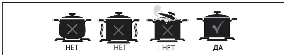
Исключением является ВОК-конфорка - при приготовлении на этой конфорке допускается использование специальной посуды ВОК с вогнутым дном. Использование крышек при приготовлении также способствует сокращению времени приготовления и более эффективному использованию газа.
