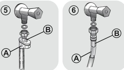
● **АКВАПРОТЕКТ** («Система захисту від протікання») – **ВОДОНАЛИВНИЙ ШЛАНГ З ДОДАТКОВИМ ЗАХИСТОМ** (**Рис.6**): Якщо вода протече з головного внутрішнього шлангу «A», то вона потрапить до прозорої захисної зовнішньої оболонки «B», що дозволить закінчити цикл прання. Після завершення циклу прання зверніться до Центру з Обслуговування Клієнтів, щоб замінити водоналивний шланг.
