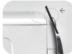
Если вы не знаете, где размещена антенна NFC на смартфоне, слегка перемещайте его круговыми движениями вокруг логотипа **Smart Touch**, до тех пока Приложение не подтвердит соединение. Для успешной передачи данных **ОЧЕНЬ ВАЖНО ДЕРЖАТЬ СМАРТФОН НА ПАНЕЛИ УПРАВЛЕНИЯ СТИРАЛЬНОЙ МАШИНЫ В ТЕЧЕНИЕ ВСЕХ НЕСКОЛЬКИХ СЕКУНД, КОГДА ИДЁТ ПЕРЕДАЧА ДАННЫХ**. Сообщение на смартфоне проинформирует Вас о правильном завершении процедуры и моменте, когда смартфон можно убрать.
