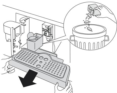
При проведении очистки обязательно полностью извлеките ванночку для сбора воды, чтобы избежать ее падения, когда извлекается контейнер для гущи.
