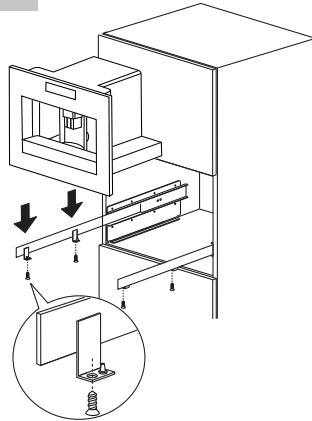
Установите прибор на направляющие, убедившись, что штифты вошли в углубления, и закрепите его прилагаемыми винтами.
