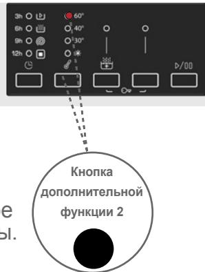
Можно постепенно понижать температуру воды для стирки от максимальной температуры, заданной для выбранной программы, и до выбора стирки в холодной воде \*, нажимая кнопку регулировки температуры.
