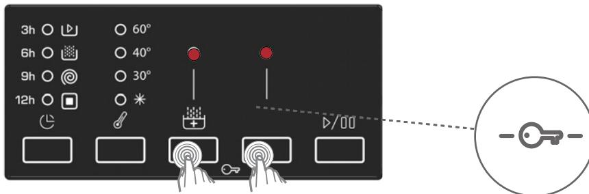
Если нажать любую кнопку при включенной функции защиты от детей, на дисплее индикаторы дополнительных функций будут мигать.
