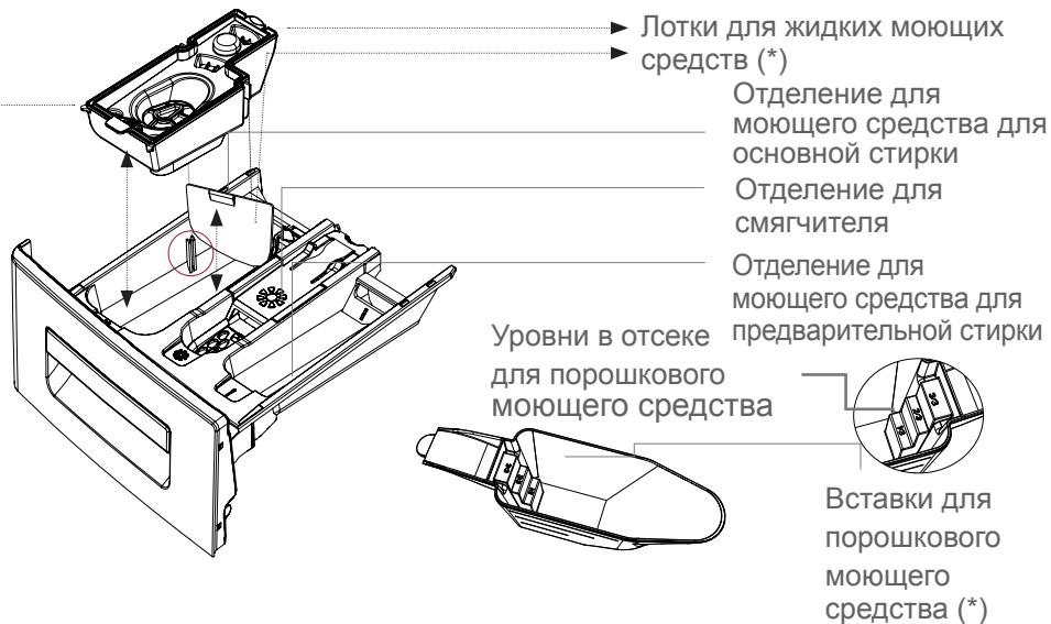
(\*) Технические характеристики могут отличаться в зависимости от модели приобретенной машины.
