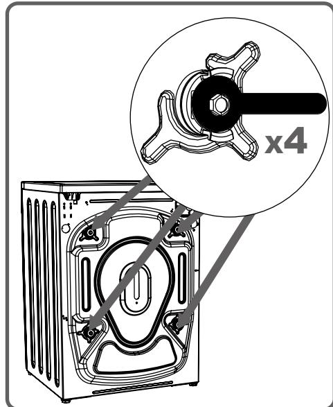
Необходимо снять транспортировочные болты путем их выкручивания.
