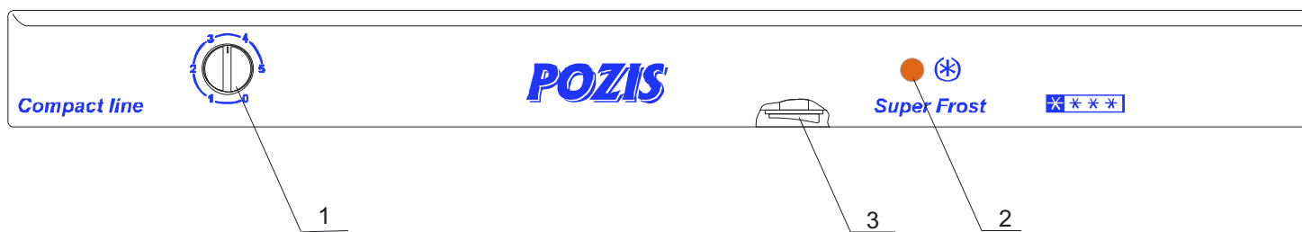
Рис.2 Схема расположения управления и сигнализации 1 – ручка терморегулятора; 2 – желтая индикаторная лампа; 3 – переключатель
