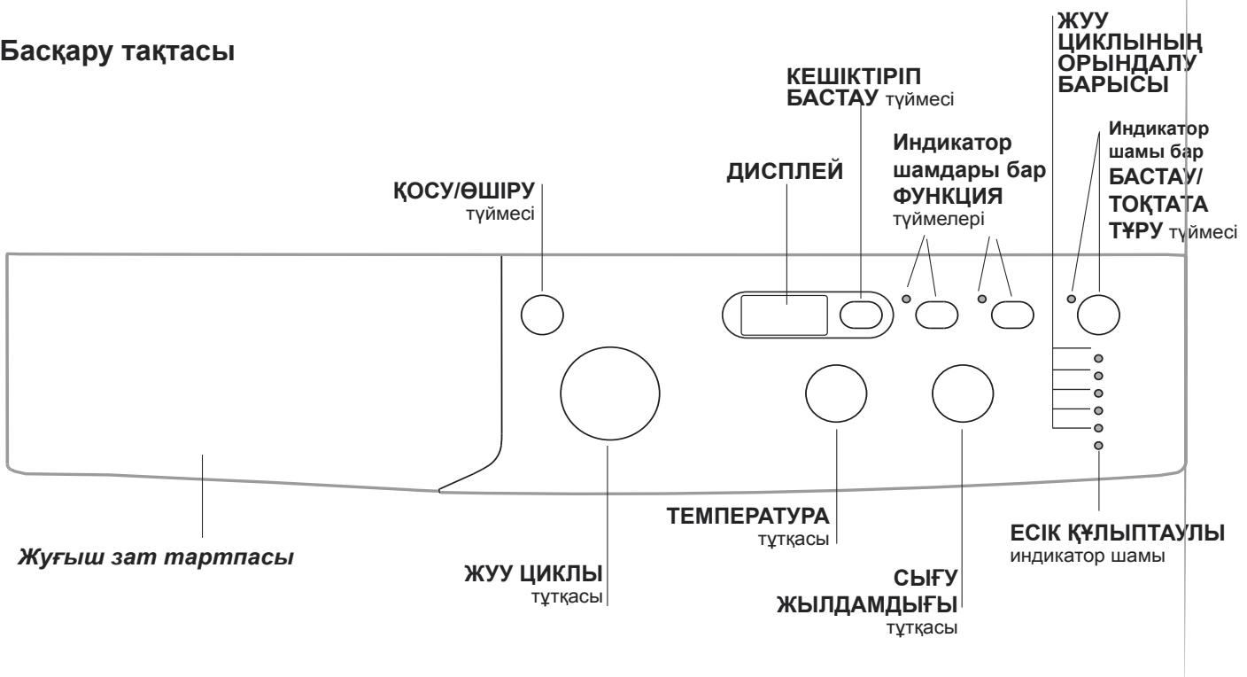
**Жуғыш заттарының түрлерін сұзату түрлері**: жуғыш заттар мен жуғыш қосындыларды енгізу үшін пайдаланылады ( «Жуғыш заттар мен кірлер» тарауын қараңыз»).
