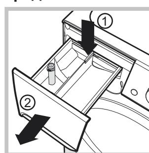
Чтобы вынуть дозатор, нажмите на язычок (1) и вытащите дозатор (2) (см. рисунок). Промойте ячейку под струей воды. Эта операция должна выполняться регулярно.
