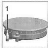
В случае отсутствия по какой-либо причине пламени в конфорках устройство газ-контроля тут же перекрывает подачу газа.
