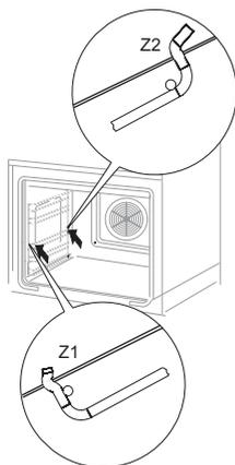
Духовки, обозначенные буквами **Dp\***, оборудованы в нержавеющие телескопические (раздвижные) направляющие, прикреплённые к проволочным проводникам. Направляющие следует вынимать и мыть вместе с проволочными проводниками. Перед размещением на них противеней, следует их выдвинуть (если духовка нагрета, проводники надо выдвинуть, зацепив задним краем противеня за буфера, которые находятся в передней части проводников) и затем ввести вместе в противенем.
