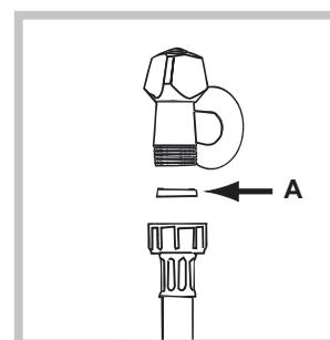
1. Вставте прокладку А у кінець шлангу для подачі води та вкрутіть його у кран з холодною водою з різьбою 3/4 (див. малюнок). Перед підключеннем спустіть воду, доки вона не стане прозорою.
