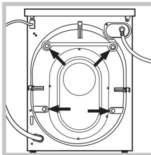
3. Видаліть 4 запобіжні гвинти для транспортування та прокладку з відповідною розрірною деталлю, які знаходяться позаду (див. малюнок).
