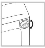
2. После установки машины на место отрегулируйте ее устойчивое положение путем вращения передних ножек (см. рис.). Для этого сначала ослабьте контргайку, после завершения регулировки контргайку затяните.
