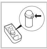
Лоток 4 для отбеливателя вставляется в отделение 1 распределителя моющих средств. Не заполняйте лоток 4 выше отметки max (см. рис.). Для осуществления только отбеливания налейте отбеливатель в дополнительную вставку
