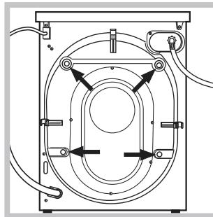
3. Видаліть 4 запобіжні гвинти для транспортування та прокладку з відповідною розріпроною деталлю, які знаходяться позаду (див. малюнок).
